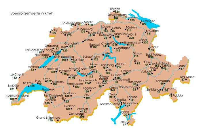
Abb. 4.10.5.: Maximale Böenspitzen einiger Stationen der SMA-MeteoSchweiz am Tag des Orkans "Lothar" (26. 12. 1999). Als Böenspitze wird die höchste, über die Dauer von 1 Sekunde gemittelte Windgeschwindigkeit bezeichnet.
