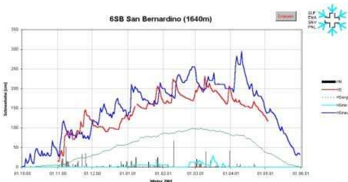
Fig. 4.1.2.1: Innevamento a San Bernardino, paragone tra l'inverno 2000-01 e il massimo rilevato a partire dal 1952. HN: altezza della neve nuova misurata giornalmente, HS: altezza della neve sul terreno durante l'inverno 2000-01, HSavg: altezza media della neve sul terreno, HSmin: altezza minima, HS max: altezza massima.
