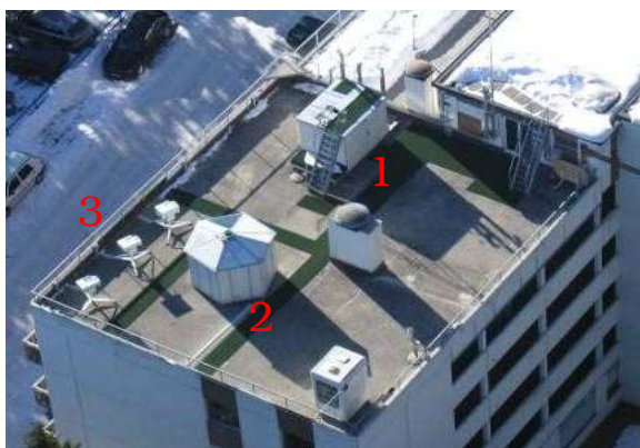
Fig. 6.1 Observatoire climatique d'Arosa sur le toit du bâtiment «Zum Steinbruch»: (1) cabine du spectrophotomètre Dobson 51, (2) carrousel des spectrophotomètres Dobson 62 et 101, (3) Spectrophotomètres Brewer 40, 72 et 156.
